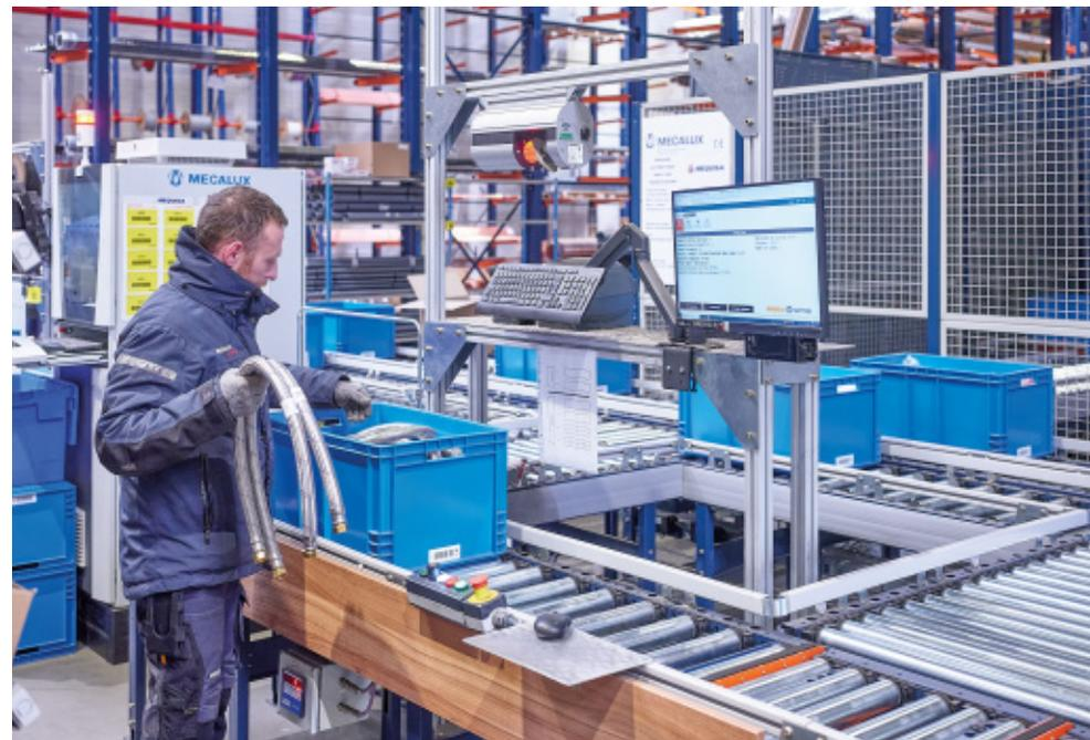
Nella parte anteriore del magazzino automatico sono state allestite due stazioni di picking, dove vengono prelevati fino a 30 ordini alla volta in base al principio "prodotto all'uomo". Gli operatori rimangono nella stazione di lavoro in attesa di ricevere la merce e smistare gli articoli nelle scaffalature per picking a gravità situate alle loro spalle.
