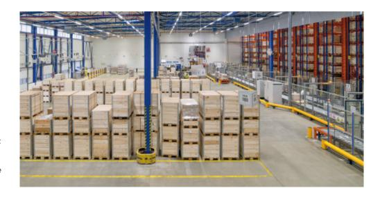
un trasloelevatore, i pallet vengono spostati automaticamente nell'ubicazione corrispondente. Una volta stoccati, il software di gestione monitora lo stato di tutte le merci in tempo reale e segnala ogni movimento che si verifica.
