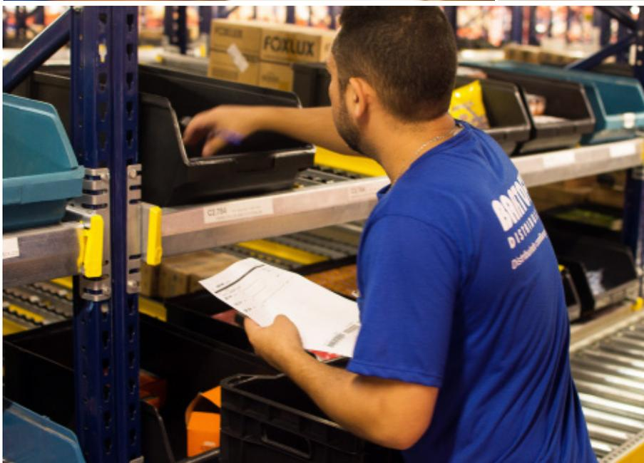
Tra i due blocchi di scaffalature a gravità si trovano scaffalature a gravità per picking. Sono composte da tre piattaforme con rotelle e sono leggermente inclinate in modo che i contenitori si spostino per gravità. Il vantaggio di queste soluzioni per il picking è che c'è sempre stock disponibile per lo svolgimento del ciclo operativo.
