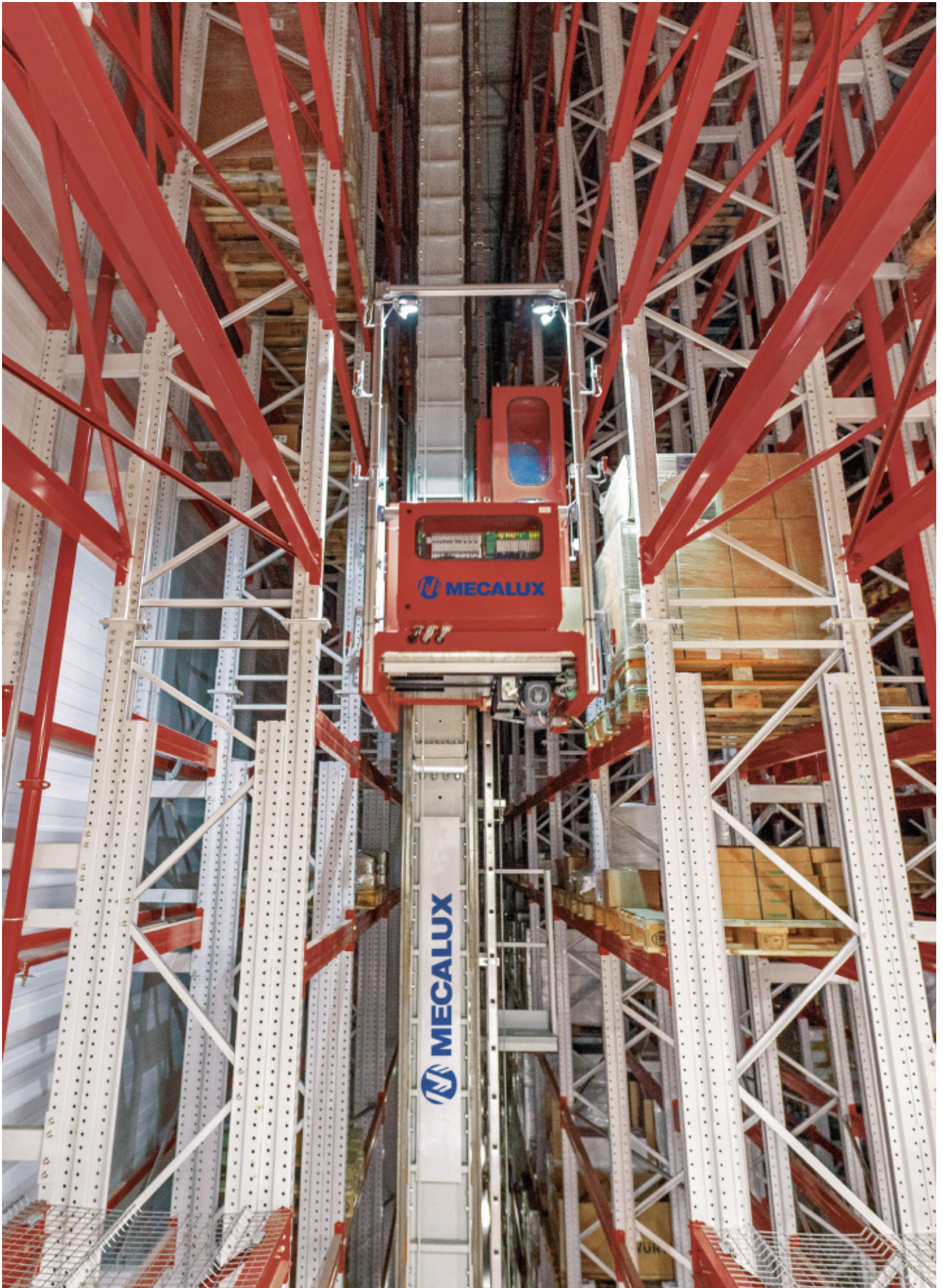
Trasloelevatore monocolonna a singola profondità con velocità di traslazione di 220 m/min e 54 m/min in elevazione.
