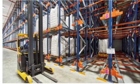
Il magazzino è diviso in quattro celle. Occupando solo lo spazio strettamente necessario, l'azienda risparmia i costi energetici per il mantenimento dell'installazione a una temperatura controllata di 4°C
