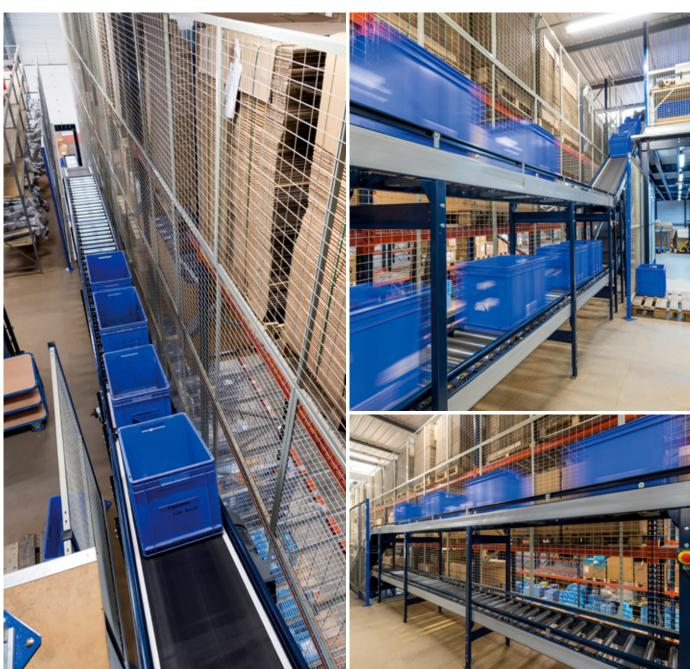
Lungo il percorso, è presente una combinazione di nastri e rulli. I nastri inclinati sono molto utili per superare i dislivelli del magazzino.
