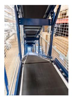
Il circuito si conclude nell'area di consolidamento. Qui, si termina l'imballaggio, l'etichettatura e l'emissione dei documenti necessari per la spedizione dell'ordine. A causa dell'elevato numero di ordini elaborati quotidianamente, sono state installate una nastratrice e una reggiatrice completamente automatiche.
