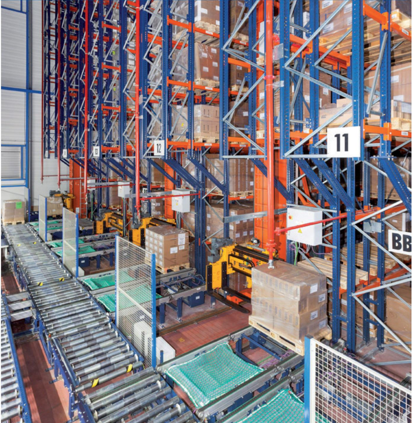
Il centro logistico, presso le strutture che Disalfarm possiede a Rubí (Barcellona), è stato costruito su una superficie di 39.027 m<sup>2</sup>. Il magazzino, completamente automatico e con una capacità di stoccaggio di oltre di 19.000 posti pallet, ha migliorato notevolmente la produttività dell'azienda. Tutto ciò, senza mai smettere di funzionare durante l'ampliamento e la modernizzazione del magazzino.
