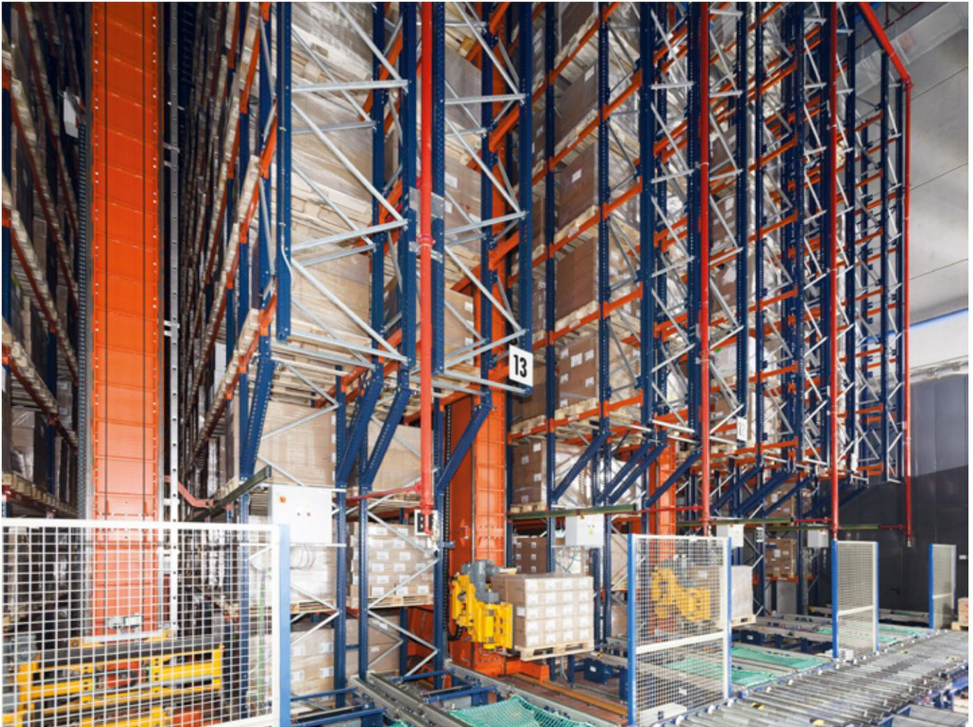
Mecalux lanciò allora sul mercato il trasloelevatore trilaterale, sostituto naturale dei carrelli trilaterali, che si adattava perfettamente alle caratteristiche che richiedeva il centro logistico di Disalfarm.
