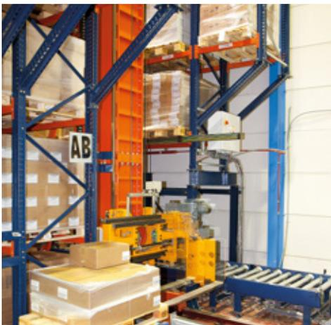
Gli accessi alle corsie per le operazioni di manutenzione del magazzino avvengono dal lato contrario alla testata, ossia dove vi era la corsia principale dell'impianto quando funzionava con i carrelli trilaterali.
