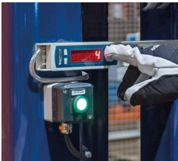
Il dispositivo luminoso (*put-to-light*) mostra il numero di referenze da depositare su ogni pallet. Al termine del processo, l'operatore preme il pulsante per trasmettere le informazioni al WMS. Questo sistema velocizza il ciclo operativo, riduce gli errori durante la preparazione degli ordini e aggiorna lo stock in tempo reale trasmettendo le informazioni al WMS.
