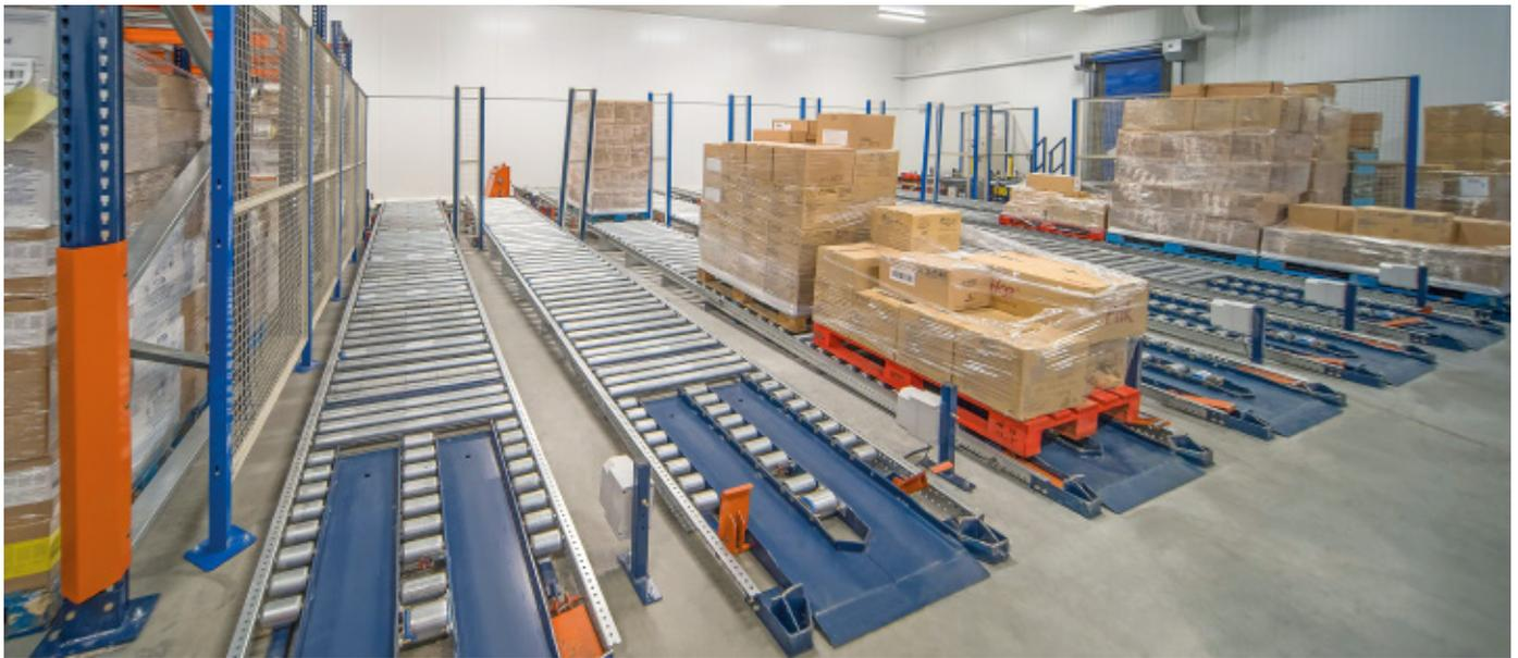
**Sicurezza della merce. L'area spedizioni opera anche a temperatura controllata per non spezzare la catena del freddo. Inoltre arresti, rulli frenanti e altri dispositivi installati nei canali di precarico controllano automaticamente la velocità e l'arresto dei pallet senza che questi provochino intasamenti o si scontrino tra loro.**
